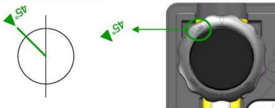
Obrázek 16: Počáteční poloha ventilu. Zpětný ventil v této poloze funguje normálně
