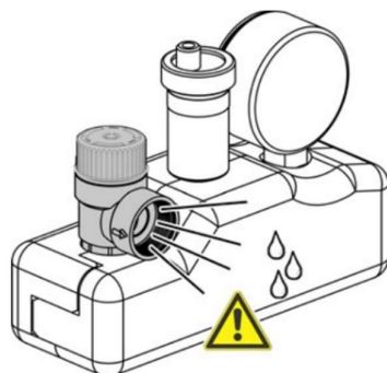
Obrázek 2. Instalace bez vypouštěcího potrubí
