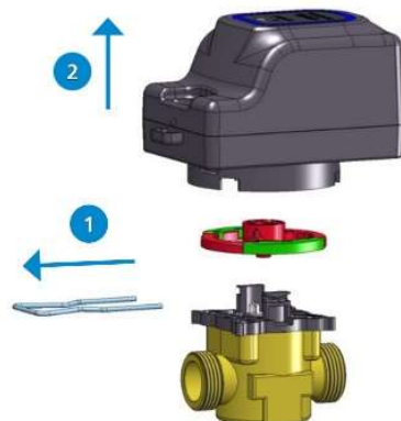
Obr. 3 Postup demontáže pohonu z ventilu
