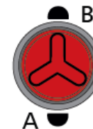
Obr. 2. Ukazatel aktuální polohy ventilu na pohonu
